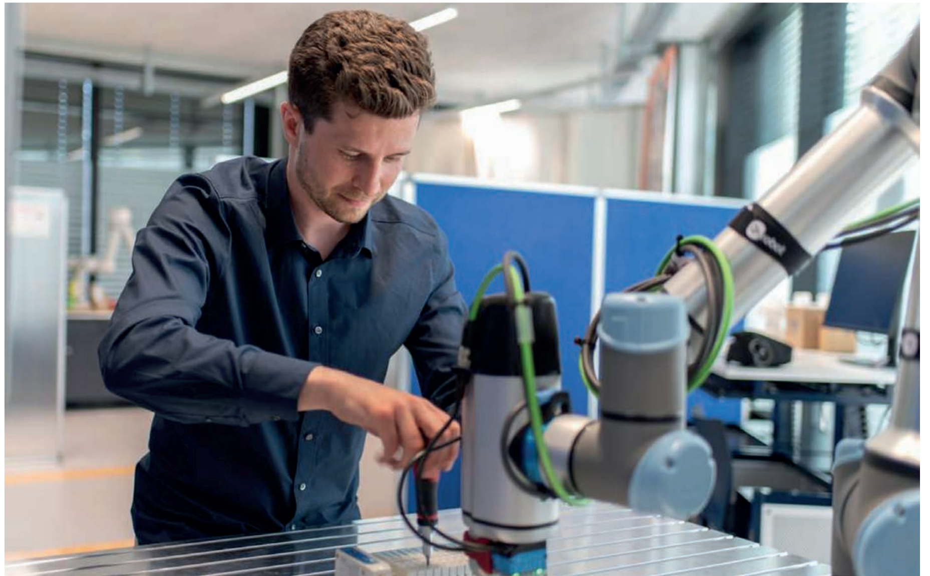
David Weder en train de visser des valves à l'aide d'un robot dans les locaux biennois du Switzerland Innovation Park.
